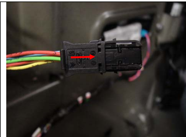
Bild 10: Verriegelung von hinten aufschieben (muss hörbar einrasten)
