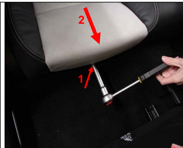
Bild 1: Rückbank ausbauen: 2 Schrauben unter der Rückbank lösen, Rückbank kräftig nach vorne herausziehen
