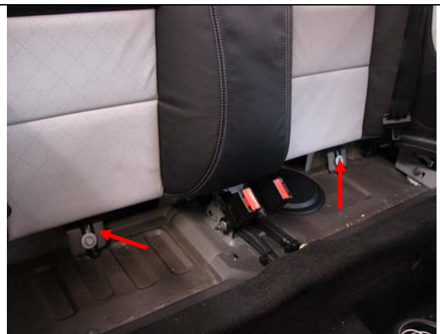
Bild 2: Rückenlehne ausbauen: 2 Schrauben lösen und Rückenlehne nach oben herausnehmen
