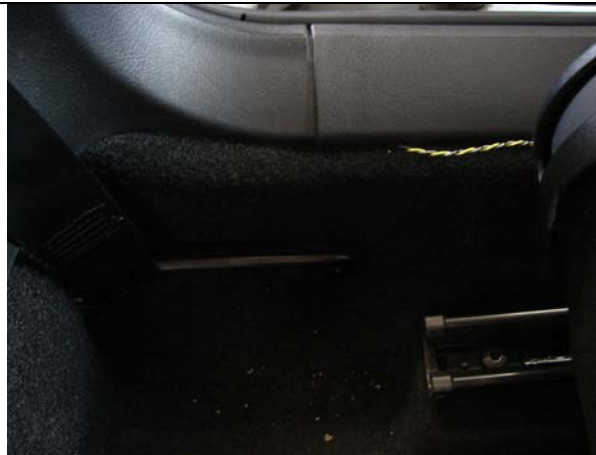
Bild 19: Kabel unter die Schwellerverkleidung auf der Fahrerseite schieben
