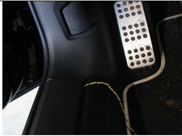
Bild 20: Kabel bis nach vorn verlegt, Kabel hinter der Verkleidung nach oben führen
