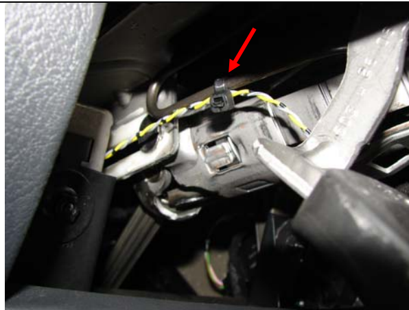
Bild 21: Kabel befestigen (Achtung: Kabel darf nicht mit drehenden Teilen des Lenkgestänges in Berührung kommen)
