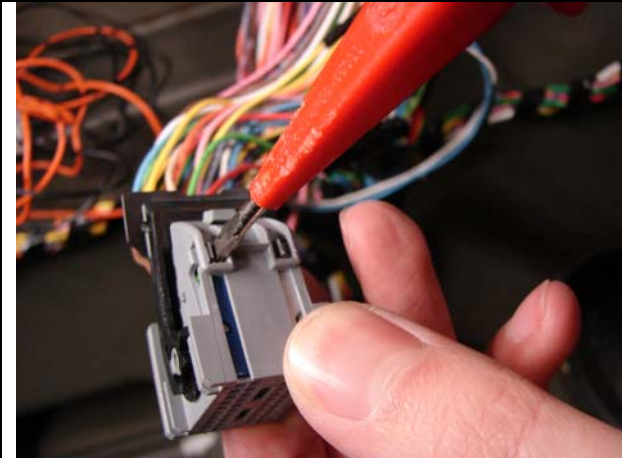
Bild 6: Kontaktleiste aus Stecker nehmen: Bügel zurückklappen (1), dann Lasche nach aussen drücken (2) und beide Kontaktleisten herausziehen
