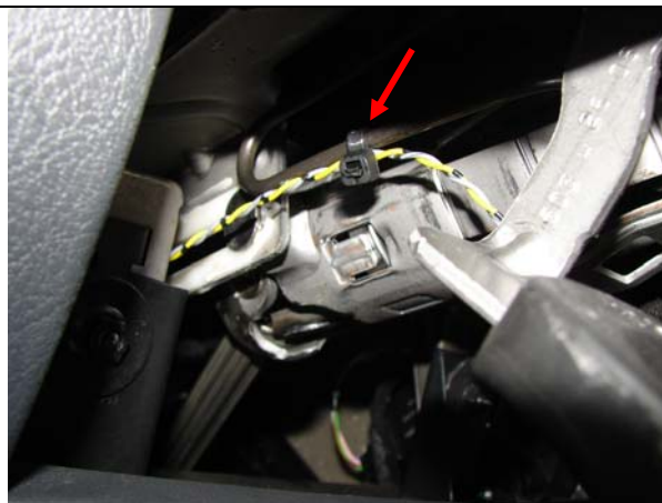
Bild 21: Kabel befestigen (Achtung: Kabel darf nicht mit drehenden Teilen des Lenkgestänges in Berührung kommen)
