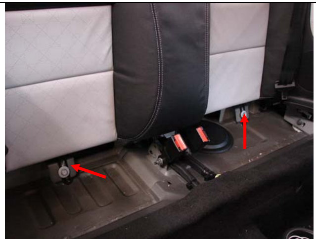
Bild 2: Rückenlehne ausbauen: 2 Schrauben lösen und Rückenlehne nach oben herausnehmen
