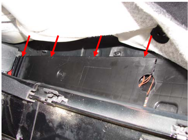
Bild 4: Kabelkanal, vierfach gerastet
