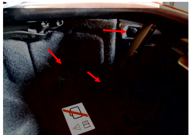
Bild 4: Beifahrerseite Seitenverkleidung: drei Spreiznieten entfernen
