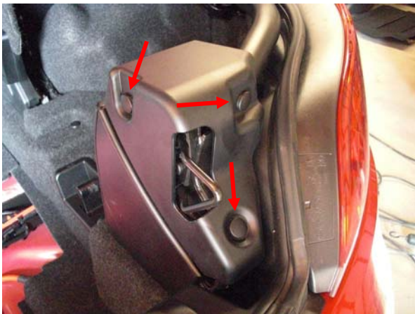
Bild 1: Beifahrerseite Heckdeckelverriegelung: drei Spreiznieten entfernen
