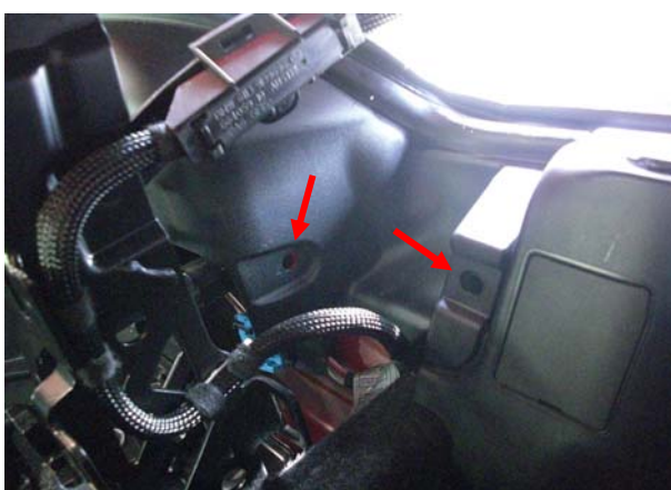
Bild 5: zwei Spreiznieten entfernen
