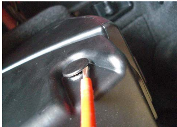
Bild 2: Spreizniete entfernen: Kopf mit Schraubendreher heraushebeln, dann kann Niete herausgezogen werden
