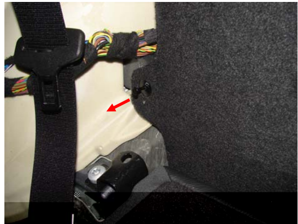
Bild 8: Plastikniete entfernen, dazu erst den Stift in der Mitte herausziehen
