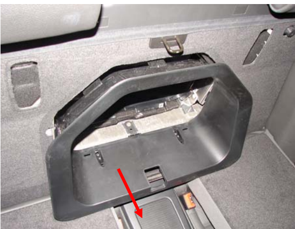
Bild 5: Durchlade entfernen (ist gerastet, kräftig nach vorne ziehen)
