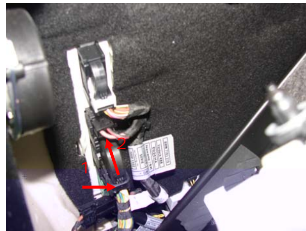
Bild 10: Stecker lösen: dazu erst Rastnase nach unten drücken (Pfeil 1), dann Bügel nach oben klappen (Pfeil 2)
