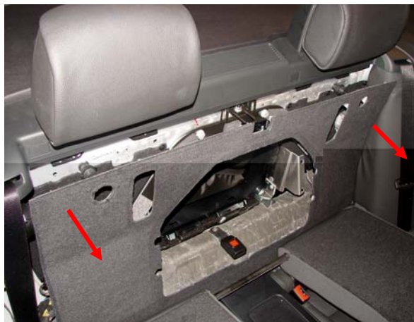
Bild 9: Abdeckung nach vorn klappen (ist oben mehrfach gerastet)
