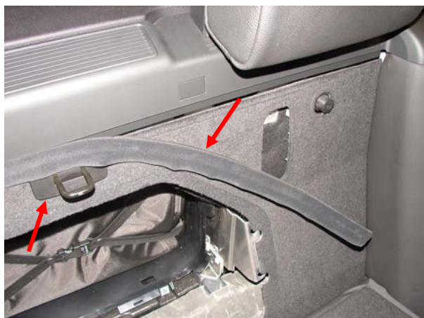
Bild 6: Dichtleiste nach unten abziehen, Abdeckung nach vorne abziehen
