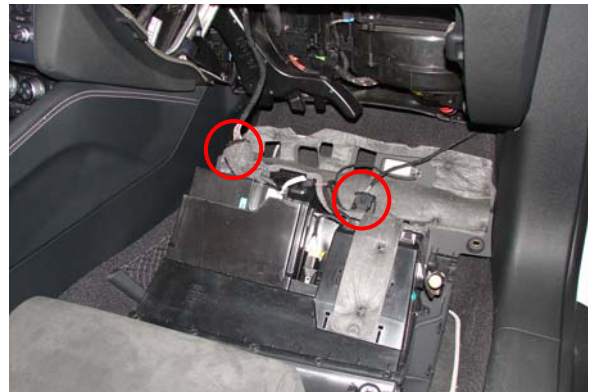
Bild 6: Handschuhfach ausgebaut. Alle Steckverbindungen lösen (hier zwei) und Handschuhfach herausnehmen
