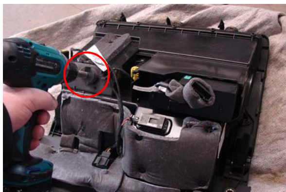
Bild 7: Loch \varnothing 35\text{mm} in Handschuhfach bohren (für Kabeldurchführung)
