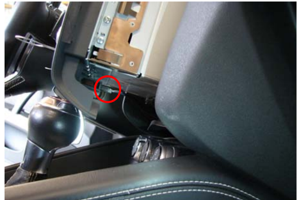
Bild 2: RNS-E herausziehen, Stecker Airbag-Leuchte abziehen
