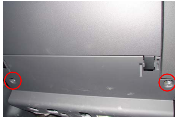
Bild 4: Handschuhfach ausbauen, dazu 5 Schrauben lösen
