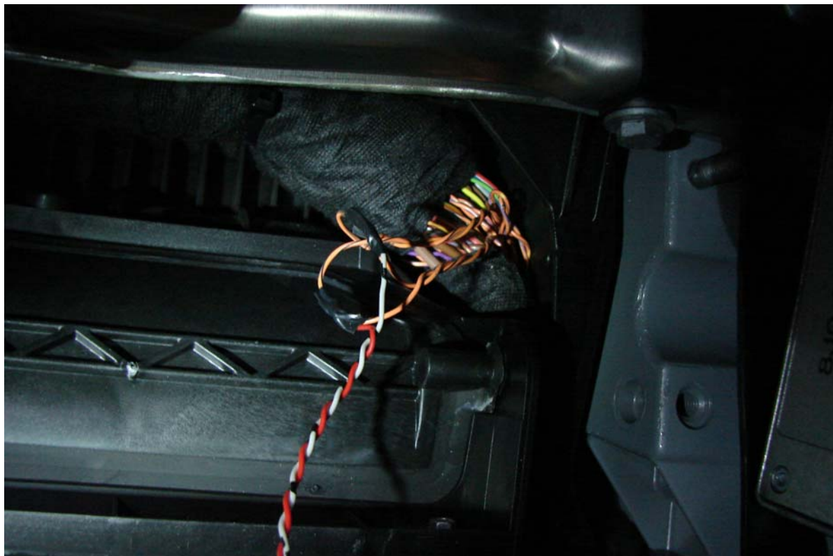
Bild 13: das rot/graue Kabel wird mit dem orange/schwarzen und das graue mit dem orange/braunen Kabel verbunden
