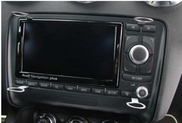
Bild 1: Entriegelungshaken am RNS-E einrasten. Blende aufklappen, um den Haken oben links einstecken zu können
