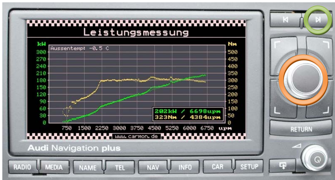
beispielhafte Bildschirmansicht (Messung P_{\max} = 202\text{kW} / M_{\max} = 323\text{Nm} )
