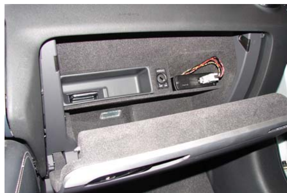
Bild 15: Handschuhfach wieder eingebaut und carmon angesteckt
