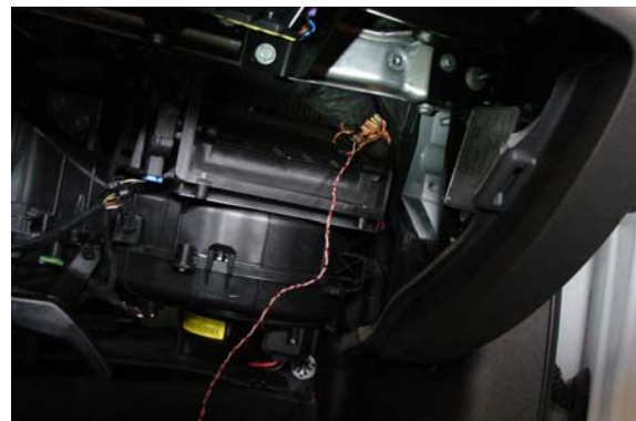
Bild 12: Anschluss Motor-CAN am Kabelbaum hinter dem Handschuhfach
