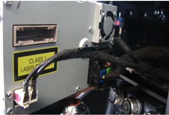
Bild 3: alle Stecker hinten am RNS-E entfernen, vorher die jeweilige Verriegelung lösen
