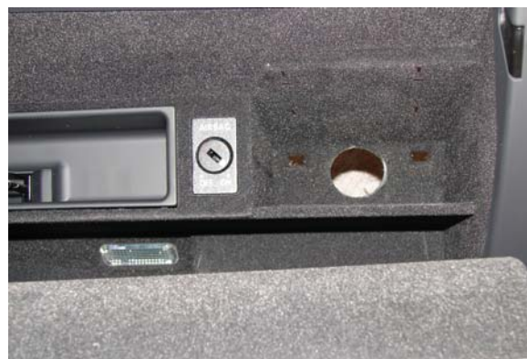
Bild 8: Ansicht Bohrung Kabeldurchführung von vorn
