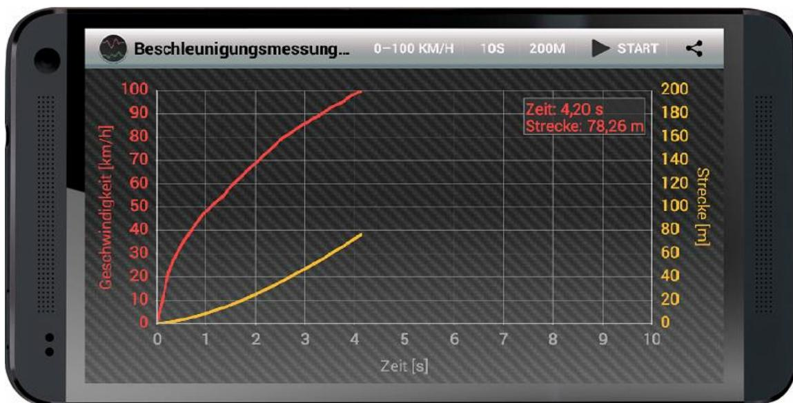
beispielhafte Bildschirmansicht (Messung 0-100Km/h in 4.20s, benötigte Strecke: 78.26m)
