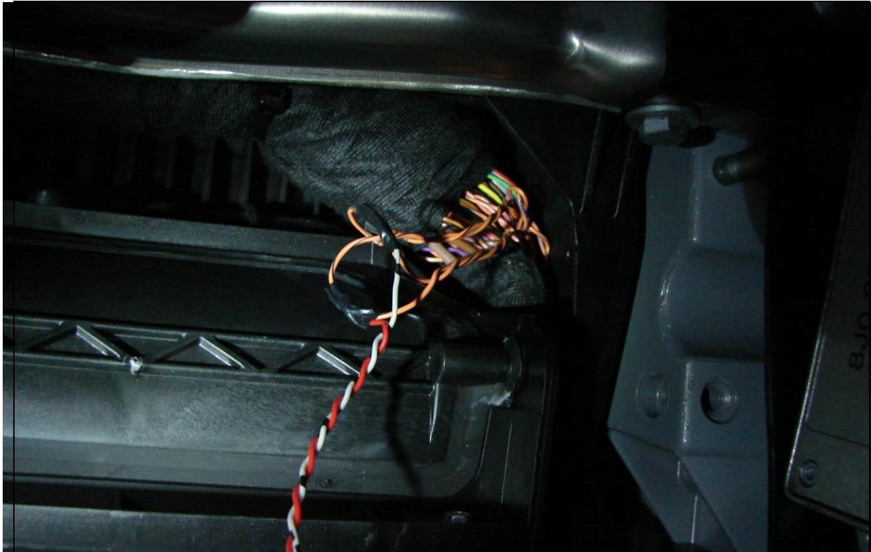
Bild 5: das rot/graue Kabel wird mit dem orange/schwarzen und das graue mit dem orange/braunen Kabel verbunden
