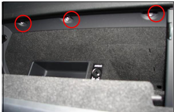
Bild 2: drei Schrauben innen im Handschuhfach lösen
