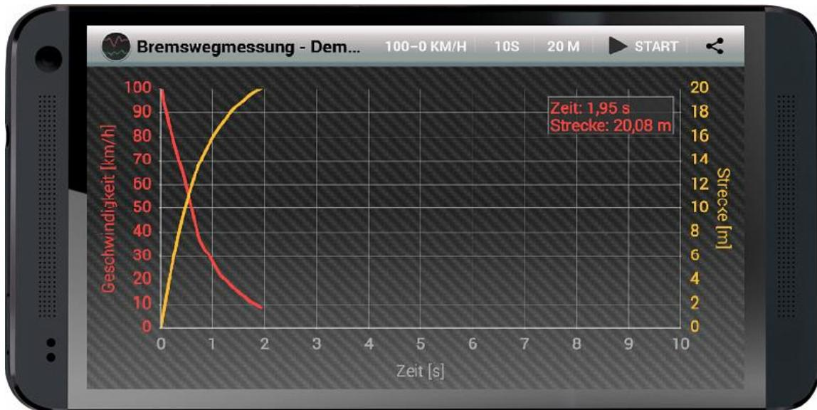
beispielhafte Bildschirmansicht (Messung 100-0Km/h in 20.02m, Bremsvorgang dauert 1.95s)
