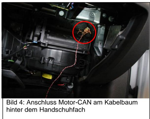
Bild 4: Anschluss Motor-CAN am Kabelbaum hinter dem Handschuhfach
