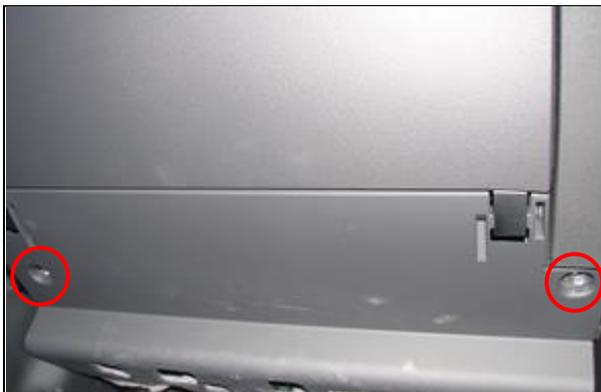
Bild 1: Handschuhfach ausbauen, dazu 5 Schrauben lösen. Hier im Bild sind zwei Schrauben unten zu lösen.
