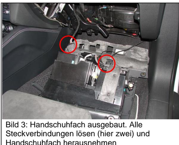
Bild 3: Handschuhfach ausgebaut. Alle Steckverbindungen lösen (hier zwei) und Handschuhfach herausnehmen
