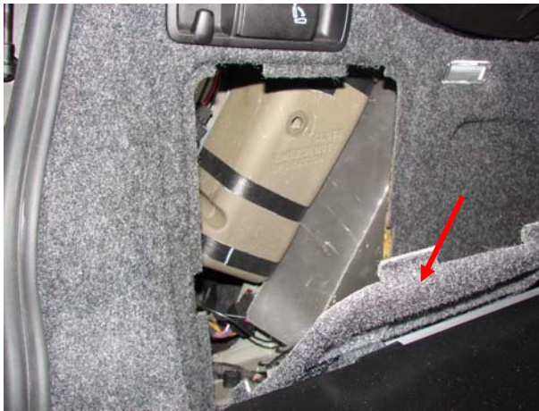
Bild 1: Abdeckung in auf der Fahrerseite im Kofferraum herausnehmen (Pfeil)
