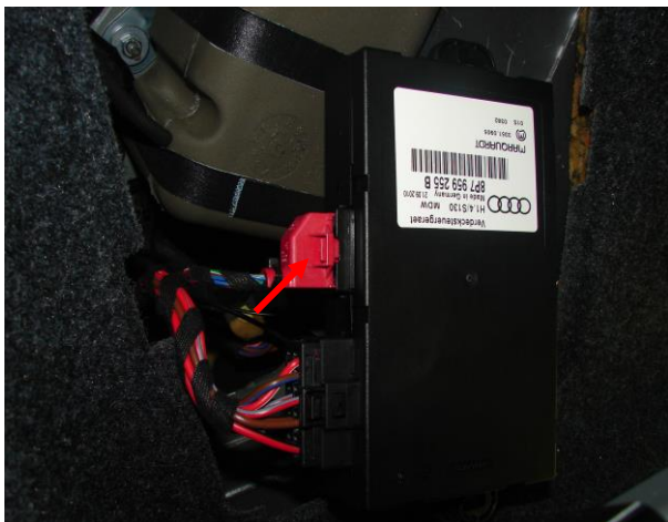
Bild 3: Stecker (rot) herausziehen, Verriegelung dazu nach unten drücken
