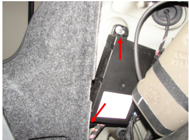
Bild 2: Verdecksteuergerät abschrauben (2 Muttern SW10, siehe Pfeile im Bild)
