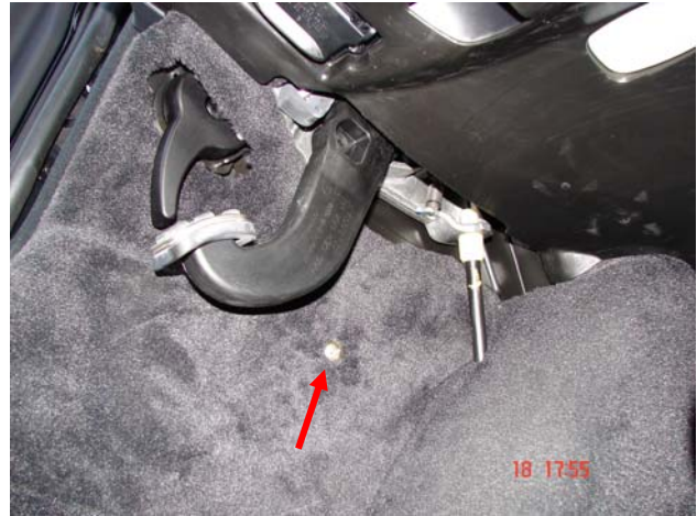
Bild 2: Abdeckung, dann Schraube entfernen
