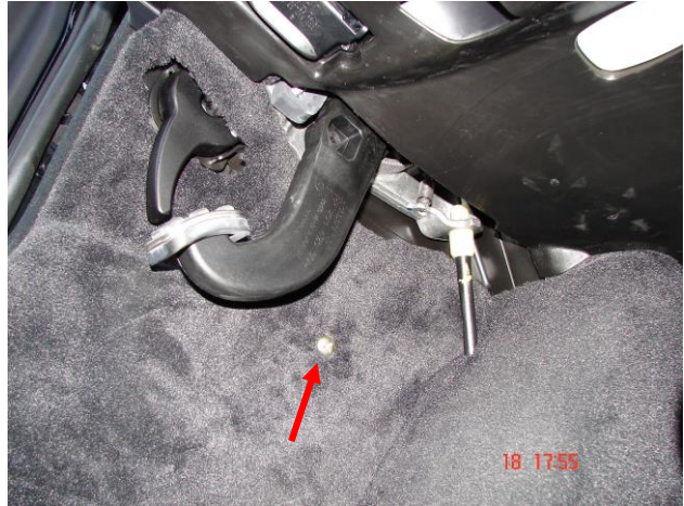
Bild 2: Abdeckung, dann Schraube entfernen
