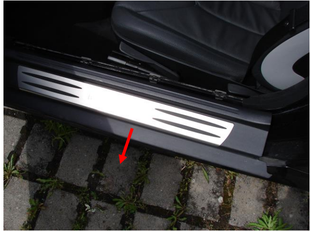
Bild 2: Einstiegsleiste seitlich herausziehen
