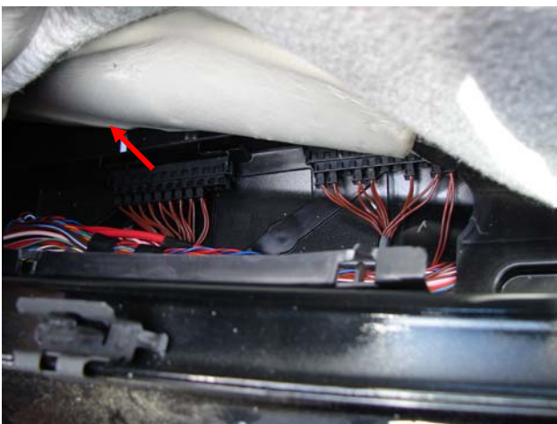
Bild 5: Kabelkanal geöffnet, CAN-Verteiler
