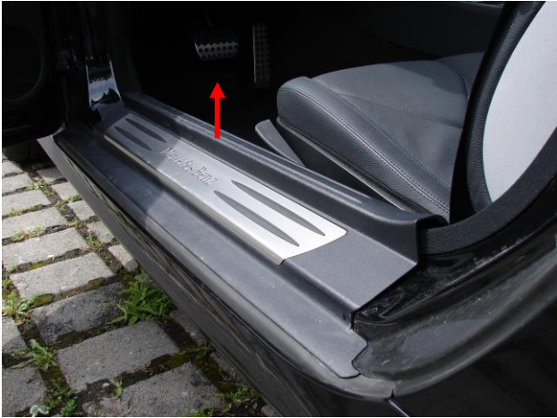
Bild 1: Einstiegsleiste hinten hochziehen
