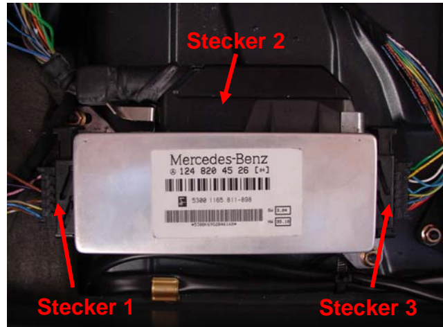
Bild 2: Verdecksteuergerät: entfernen Sie das Isolierband um den Kabelbaum zu Stecker 1 und Stecker 2
