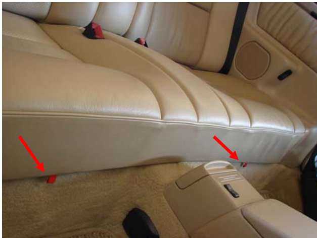
Bild 1: Rückbank entfernen: die beiden Hebel drücken und die Bank nach oben ziehen
