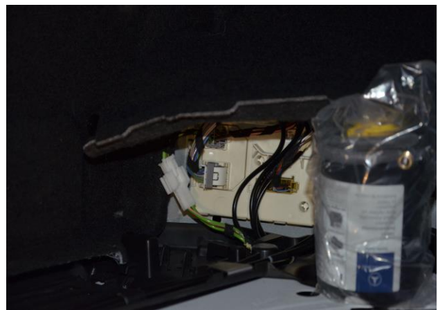
Bild 2: Verkleidung hinten rechts hochklappen und z.B. Pannenset unterstellen, um an das Verdecksteuergerät zu gelangen
