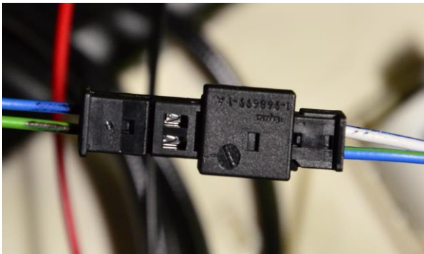
Bild 6: verbinden Sie die den ersten 2-poligen Stecker mit dem Modul. Achten Sie darauf, dass das Kabel blau/grün mit grün bzw. weiß/blau mit blau verbunden ist.
