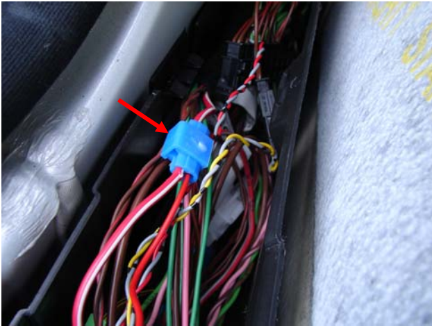
Bild 7: Anschluß +12V des Moduls
