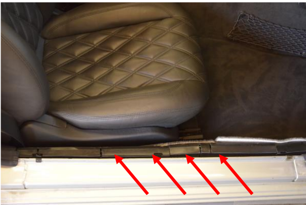
Bild 3: Kabelkanal öffnen (rote Pfeile)
