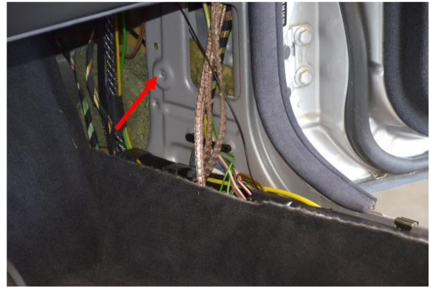
Bild 2: Seitenverkleidung im Beifahrerfußraum abschrauben (eine Schraube, Position siehe roter Pfeil)
