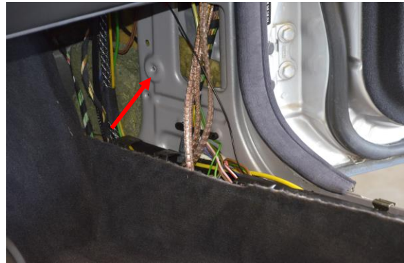
Bild 2: Seitenverkleidung im Beifahrerfußraum abschrauben (eine Schraube, Position siehe roter Pfeil)
