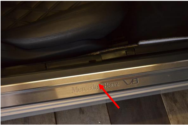
Bild 1: Beifahrersitz ganz nach hinten fahren und Einstiegsleiste (roter Pfeil) nach oben abziehen (ist nur geclipst)
