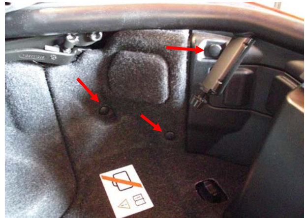
Bild 4: Beifahrerseite Seitenverkleidung: drei Spreiznieten entfernen
