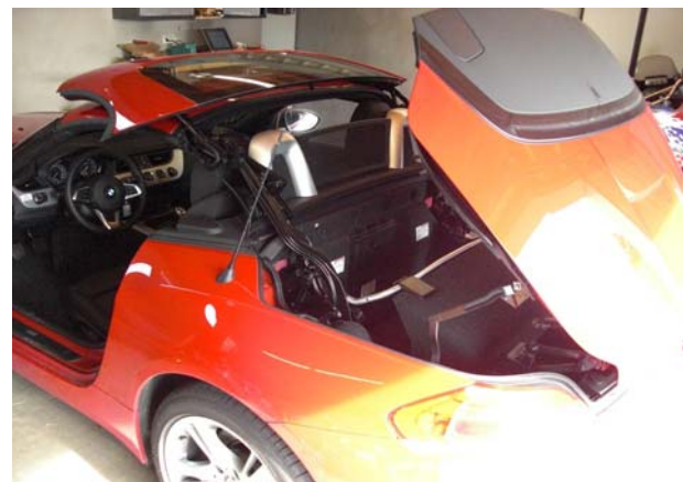
Bild 6: Dach öffnen und in dieser Stellung anhalten, danach Schlüssel wieder abziehen
