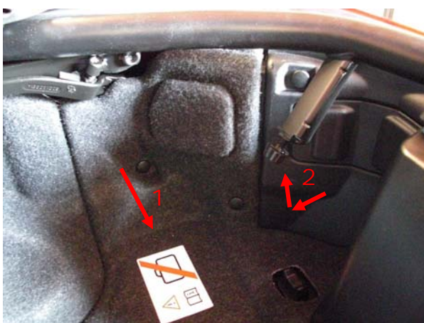
Bild 7: ziehen Sie die Verkleidung 1 heraus, danach die Verkleidung 2
