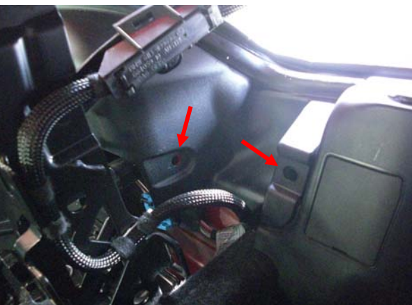
Bild 5: zwei Spreiznieten entfernen
