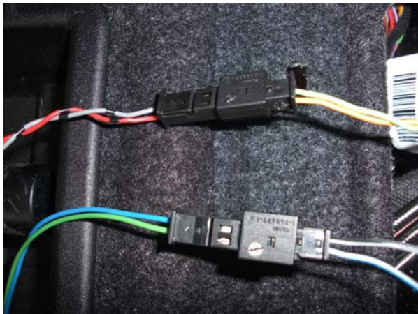
Bild 13: die 4 entfernten Kabel werden in die beigelegten Steckerhülsen gesteckt:
