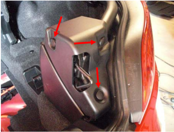
Bild 1: Beifahrerseite Heckdeckelverriegelung: drei Spreiznieten entfernen
