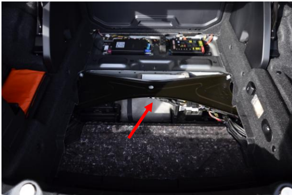
Bild 1: Kofferraum matte entnehmen, Dachsteuergerät befindet sich mittig unter der schwarzen Querstrebe (roter Pfeil)
