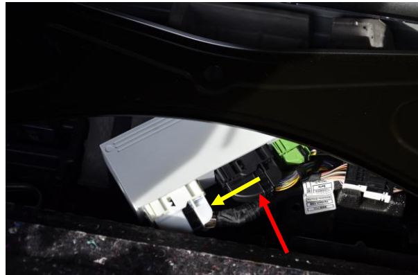
Bild 2: Schwarzen stecker lösen: Rastnase drücken (roter Pfeil), dann Bügel nach links umlegen (gelber Pfeil)
