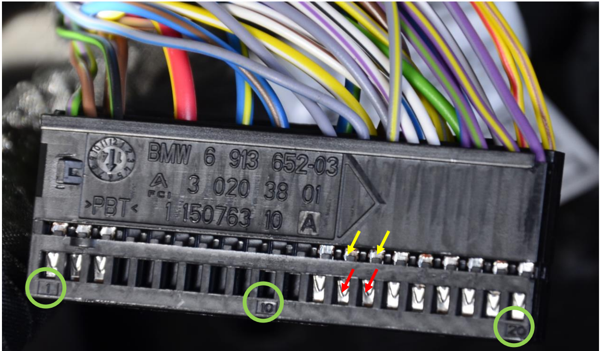
Bild 4: Kabel grau/blau (grau mit blauem Streifen, Pin 13) und grau/gelb (grau mit gelbem Streifen, Pin 14) aus dem Stecker ziehen. Auf der anderen Steckerseite müssen die Kabel gelb/rot (Pin 40) und gelb/braun (Pin 41) aus dem Stecker gezogen werden. Dazu mit einem Schraubendreher die Rastnase nach unten drücken (roter Pfeil), dann das Kabel etwas herausziehen und die Rastnase nochmals (2. Verriegelung) nach unten drücken (gelber Pfeil). Jetzt kann das Kabel vollständig aus dem Stecker gezogen werden. Die Pinnummern sind auf dem Stecker aufgedruckt (grüne Kreise).
