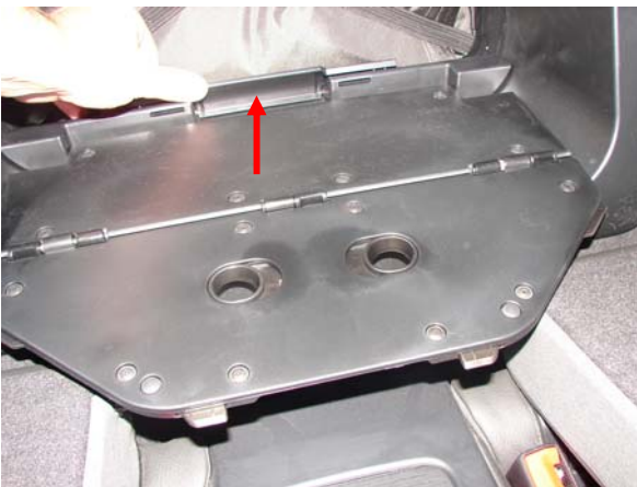
Bild 3: Abtrennung Durchlade entfernen, dazu Hebel (roter Pfeil) nach oben drücken
