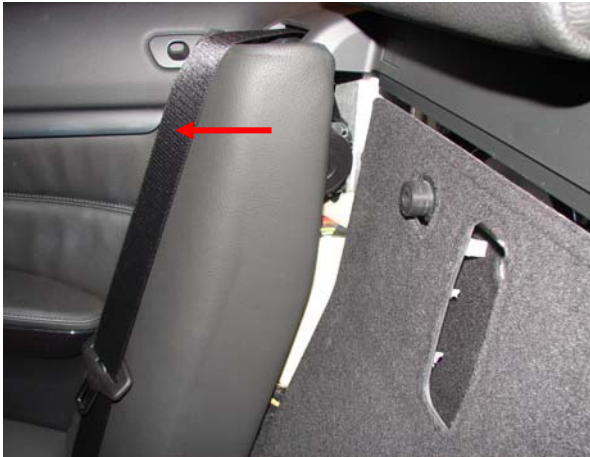
Bild 7: Seitenteil auf der Beifahrerseite nach vorne ziehen (ist gerastet)
