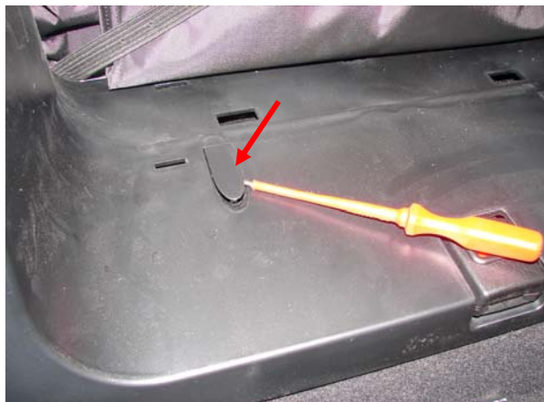
Bild 4: Abdeckungen abhebeln, Schrauben entfernen (SW10)
