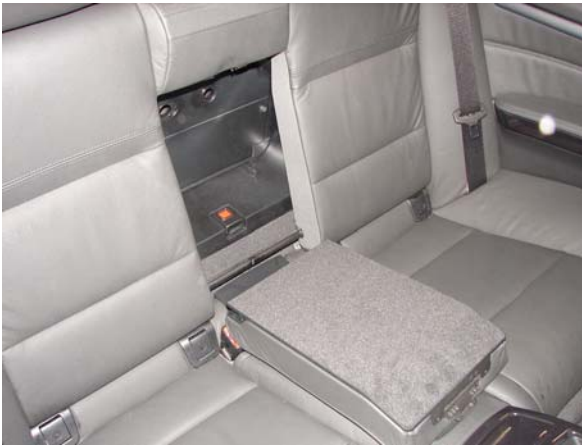
Bild 1: Mittelteil der Rücklehne herausnehmen
