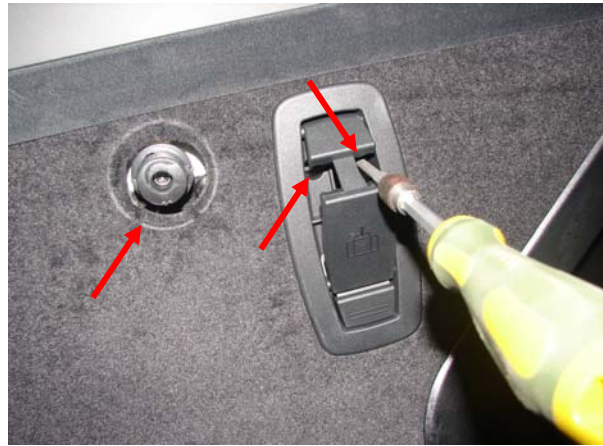
Bild 2: Plastikringe mit flachem Schraubendreher abhebeln, Kleiderbügelhalter abschrauben (2 Schrauben Torx TX20)
