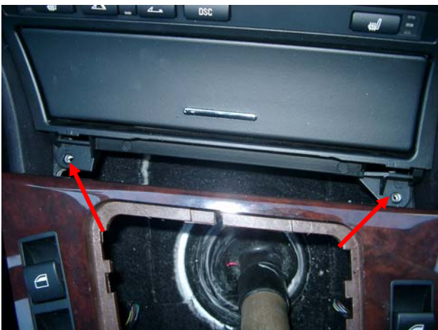
Bild 5: Schrauben Mittelkonsole unten
