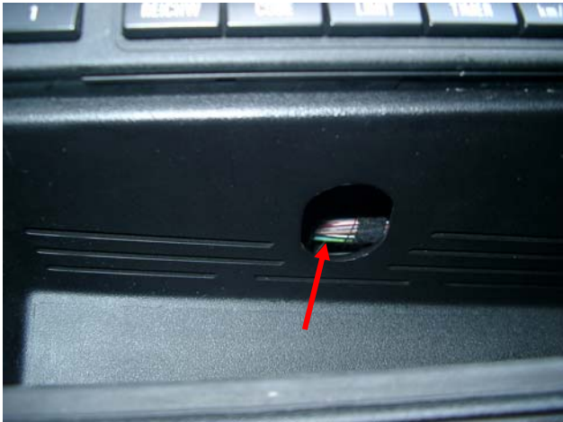
Bild 1: Ausbau Einsatz Mittelkonsole
