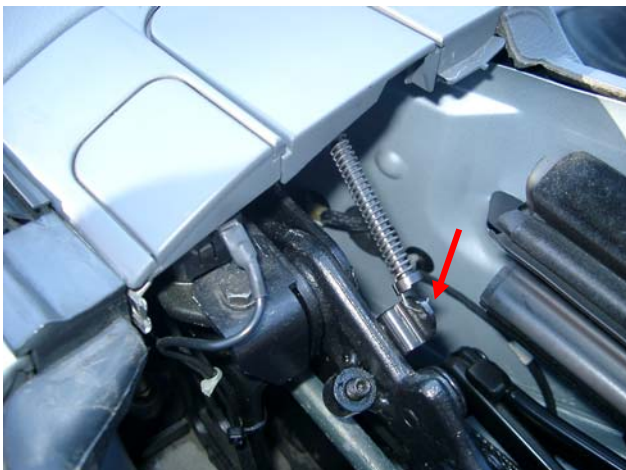
Bild 3: Feder für Klappdeckel
