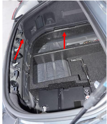
Bild 2: Styroporeinsatz entfernen und Kunststoffverkleidung am Schloss nach oben abziehen (Pfeile im Bild)
