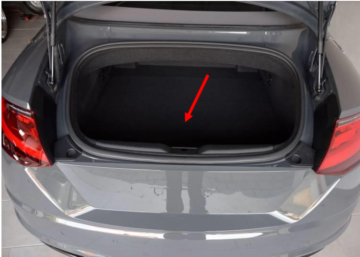
Bild 1: Kofferraum öffnen und Abdeckmatte herausnehmen (Pfeil)
