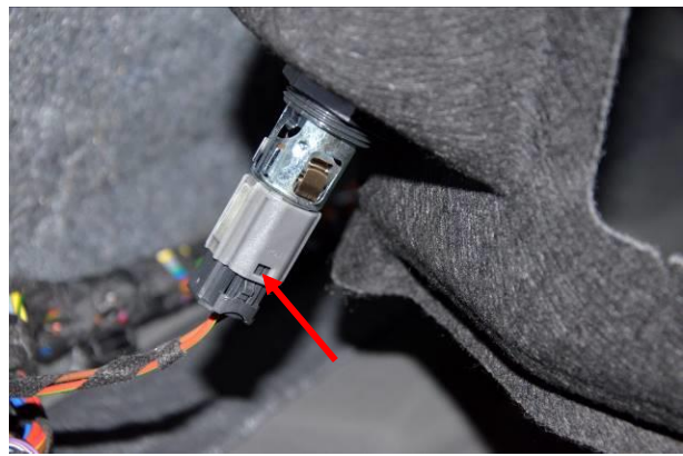
Bild 4: Stecker zum Zigarettenanzünder lösen, dazu mit einem spitzen Gegenstand die Rastnase nach unten drücken (Pfeil)
