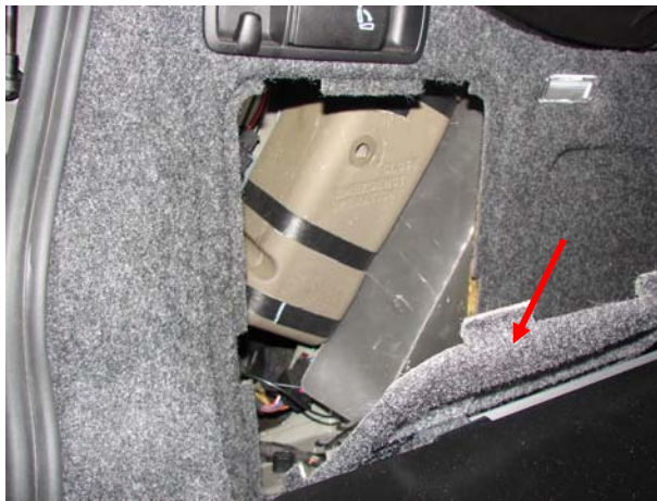
Bild 1: (nur Audi A3): Abdeckung in auf der Fahrerseite im Kofferraum herausnehmen (Pfeil)
