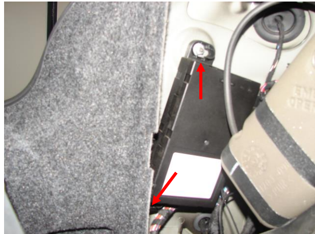
Bild 2: (nur Audi A3): Verdecksteuergerät abschrauben (2 Muttern SW10, siehe Pfeile im Bild)
