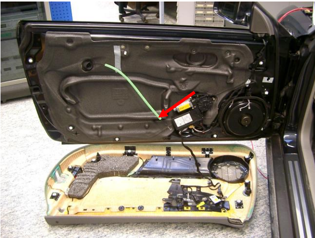
Bild 5: Seilzug Türöffner aushängen
