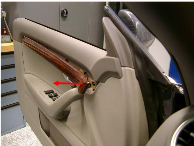
Bild 1: Zierleiste von vorn abnehmen
