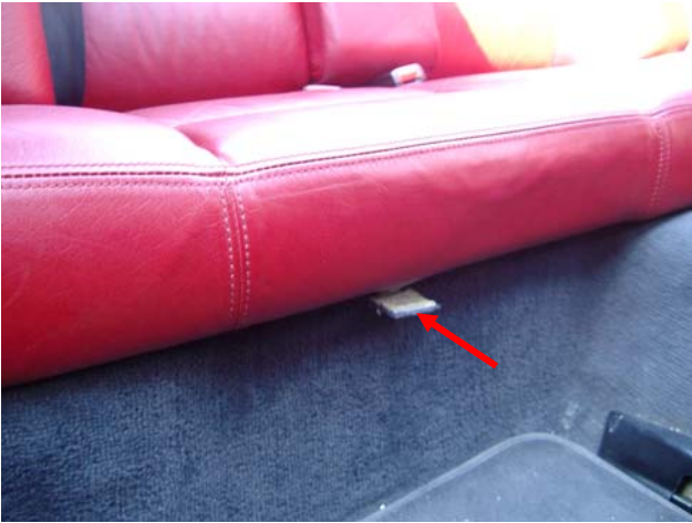
Bild 1: Position Schrauben Sitzfläche
